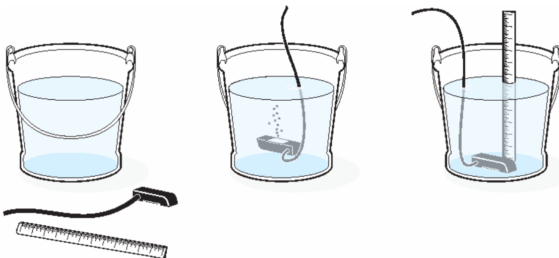
图 8 校准浸入式面积/速率传感器
